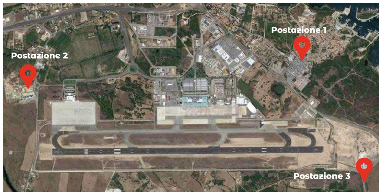
Dalle analisi effettuate mediante le rilevazioni delle centraline, due delle quali situate all'esterno della curva isofonica A ed una situata all'interno, sono emersi i risultati riportati in tabella che dimostrano il rispetto dei limiti imposti dalla caratterizzazione acustica vigente nell'aeroporto di Olbia in ottemperanza alle prescrizioni del D.M. 31/10/1997.
